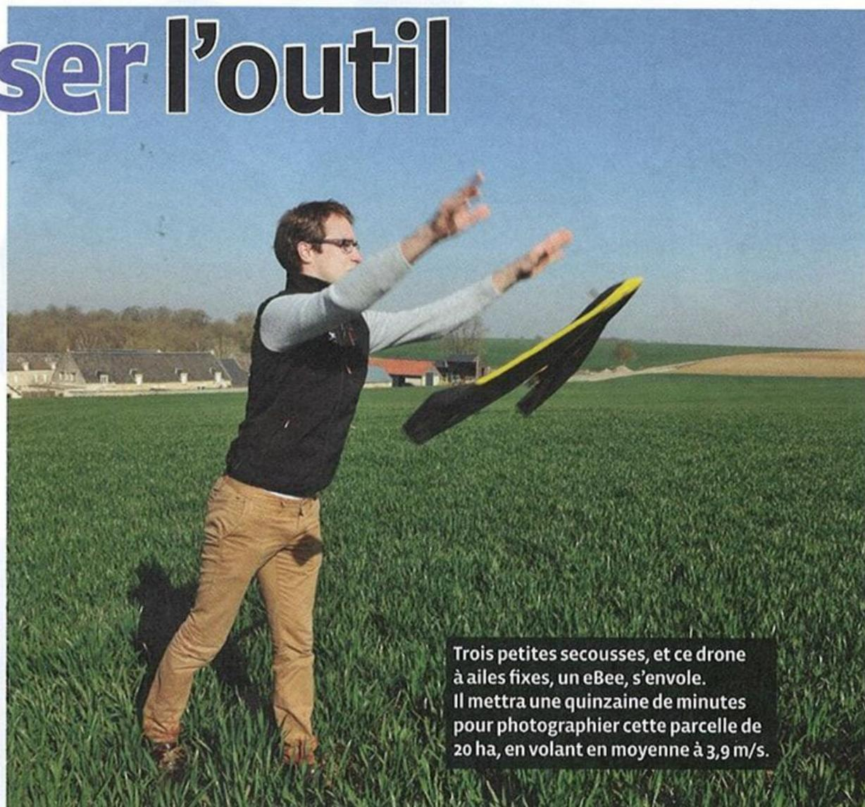
Trois petites secousses, et ce drone à ailes fixes, un eBee, s'envole. Il mettra une quinzaine de minutes pour photographier cette parcelle de 20 ha, en volant en moyenne à 3,9 m/s.
