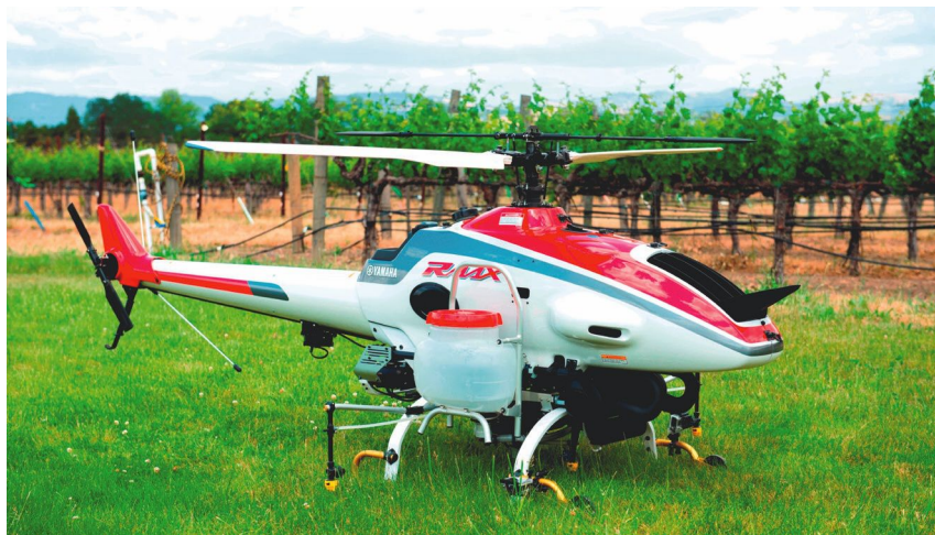
Le Yamaha Rmax peut pulvériser et traiter des parcelles, grâce à ses deux réservoirs de 8 litres chacun.
